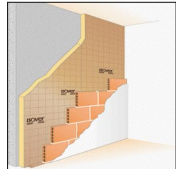
Figure 9 : Isolation d'un mur par l'intérieur
